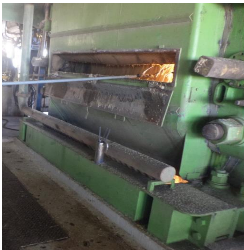
Figura 6 – Aplicação de solda (chapisco) em frisos durante a operação no primeiro terno de extração
