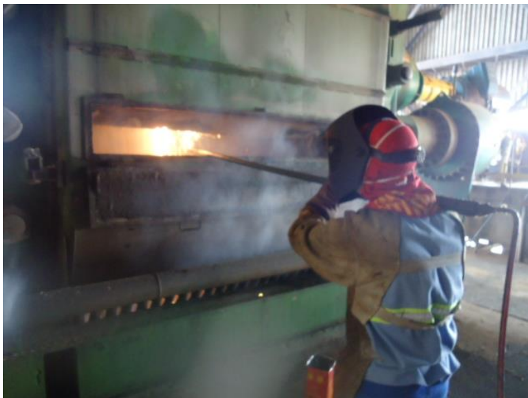
Figura 5 - Aplicação manual de solda em frisos durante a operação
